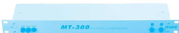
Модулятор предназначен для преобразования полного цветового видеосигнала и сигнала звукового сопровождения в радиосигнал на заказанный канале. Модулятор MT-300 изготавливается с частичным (20-30 дБ) подавлением зеркальной полосы частот. Модулятор MT-400 имеет однополосную модуляцию, что позволяет работать в смежных каналах.
